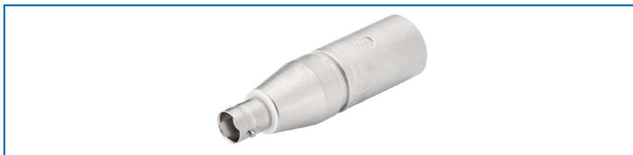
GRAS AG0003は、XLR入力とファンタム電源を備えたカードにCCPプリアンプを接続する簡単な方法を提供します。このアダプタはXLRコネクタからBNCに直接接続するため、信号チャンネルはアンバランス信号となります。AG0003は、IEC 60268-12 (「サウンドシステム機器。Part 12: Application of Connectors for Broadcast and Similar Use」)に従って配線され、図4に見られるように、ピン1と3は接地されています。したがって、マイクロホンから出力される信号とファンタム電源回路を通じて定電流を供給するために使用されるのはピン2のみです。
